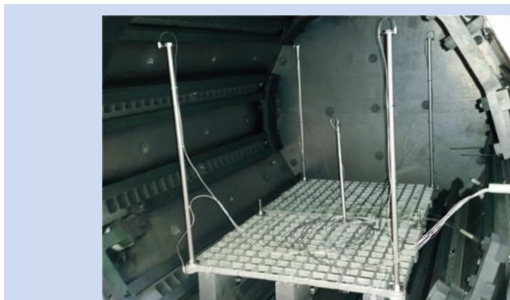
FIGURE 4 : Exemple de mannequin utilisé pour faire une cartographie dans un four BMI de la gamme B8_T.
