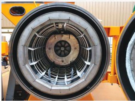
Vue d'un casing en CFC pour des applications hautes températures
