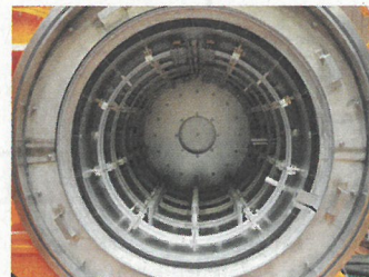
Chambre tout métal pour le traitement de pièces en titane.
